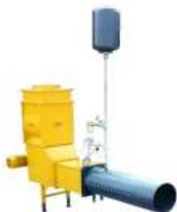
Узел подачи, состоящий из шлюза, шнека пламягасителя
